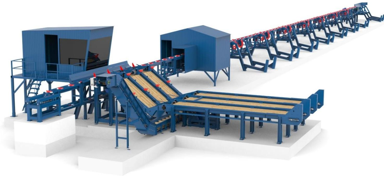
— предназначена для автоматической сортировки бревен по различным критериям (порода, длина, кривизна, диаметр, и т.п.) и распределения их в индивидуальные накопительные карманы. Применяется в лесопильных производствах средней и высокой мощности для увеличения полезного выхода готовой продукции, учета и контроля качества сырья.
